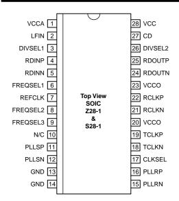
28-Pin SOIC (Z28-1) 28-Pin EPAD SOIC (S28-1)
